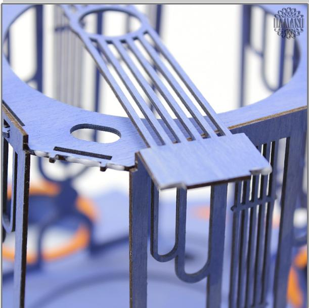
Nun werden die schmalen Seitenwände angeleimt. Geben Sie etwas Leim an die Kante und die Zapfen der Deckenplatte und an die Unterseite der Seitenwand. Achten Sie wieder darauf, dass der Zapfen selbst nicht verleimt wird. Es könnte sonst eine Leimverbindung zum Sockel entstehen.
