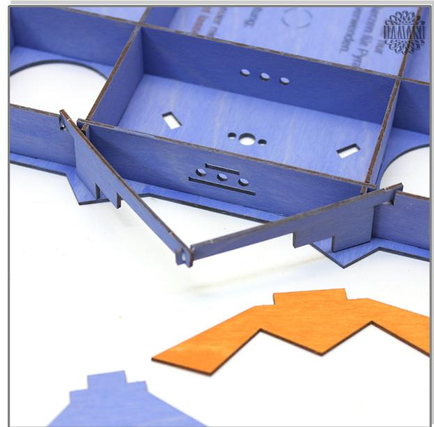
Leimen Sie die beiden Unterbauteile in die entsprechenden Aussparungen der Sockelleiste ein. Die beiden Vorderkanten der Unterbauteile haken Sie mit etwas Leim zusammen. Dazu müssen Sie die Leisten etwas verbiegen, was aber kein Problem für die Holzteile ist.
