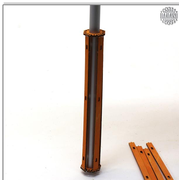
Geben Sie etwas Leim auf die oberen Leistenenden und setzen Sie einen Verbindungsring auf. Die oberen Zapfen der Leisten werden dabei jeweils in ein mittleres Loch gefädelt. Richten Sie die Leisten zur Alu-Achse gerade aus und lassen Sie alles etwas antrocknen. Beim Einleimen der oberen Leistenenden ist es nicht schlimm, wenn etwas Leim auf die Alu-Achse kommt. Das gibt dem Verbindungsring noch etwas mehr Halt an der Achse.
