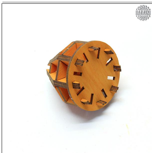
Von oben wird die Abdeckplatte aufgeleimt. Die kleinen Zapfen der Spanten sind der Anschlag für die Pyramidenachse. Ohne diese Zapfen könnte die Pyramidenachse die Abdeckplatte nach oben wegdrücken. Sollten Sie sich beim Zusammenleimen der Spanten etwas vertan haben, dann ist das nicht so schlimm. Entfernen Sie einfach die Zapfen, die nicht passen wollen. Für die Funktion müssen nicht alle acht Zapfen vorhanden sein.
