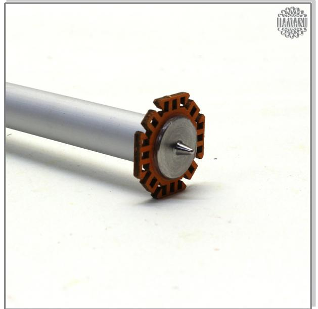
Die Achse dieser Pyramide besteht aus der Alu-Achse mit eingeleimter Pyramidenadel, einer Achsverkleidung und daran angesteckter Zierteile. Beginnen Sie mit der Vorbereitung der Achse.
